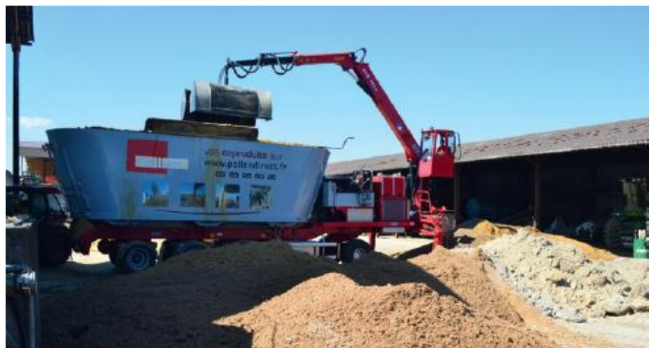
■ Brevet Pollen réalisé par Diebolt à Marmoutier. 45m 3 , moteur 500CH, grue 24 tonnes /m, 4 essieux directeurs
